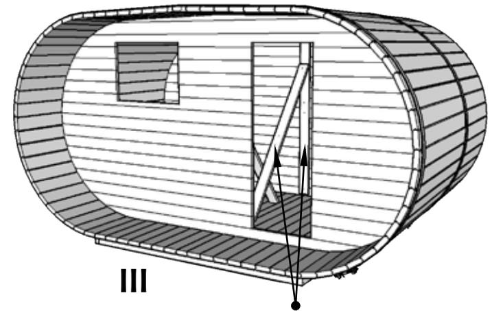
Alle inneren Behelfsstützen entfernen
