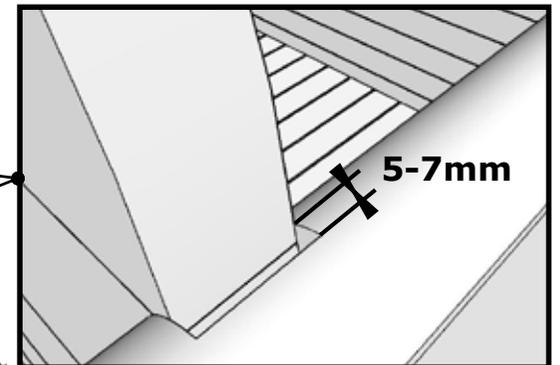
Bei der Verwendung von Thermoholz KEINE Lücke lassen
